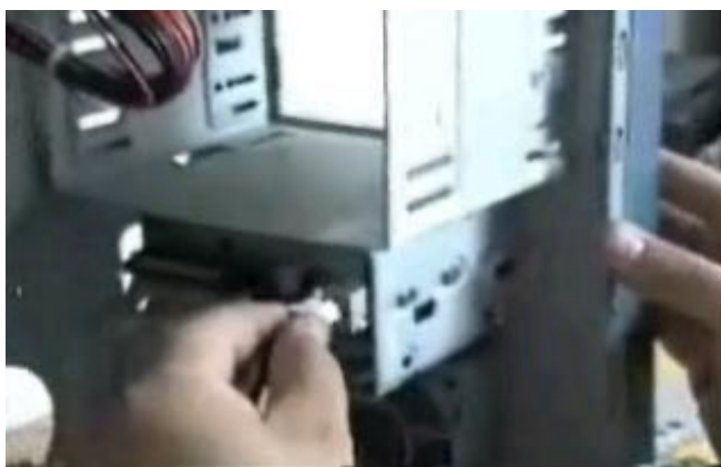
Figura 18. Conectar el cable de Datos
